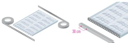
Retirar las cintas temporales de las orillas y sustituirlas con cinta aluminio en la parte alta de la instalación, y cinta ventana en la parte baja del laminado (para prevenir la entrada de polvo y suciedad, y permitir un buen drenado de la condensación). Cuando sea en arco cañón se debe colocar la cinta ventana por ambos lados.
