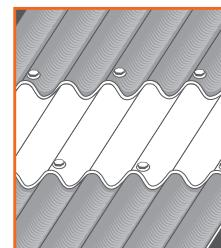
Polylit 8 se puede traslapar con lámina opaca Opalit, (también de Stabilit) para permitir el paso de la luz al interior y ahorrar energía eléctrica.
