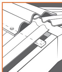
Con la lámina Polylit 8 podemos obtener cumbreñas de dos o tres ondas fijando a los apoyos de la lámina.
