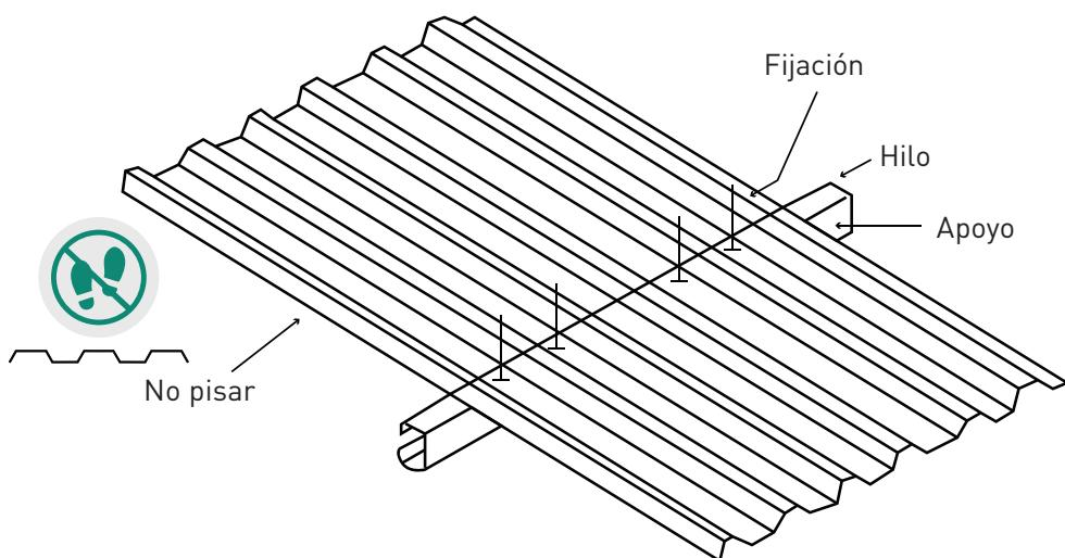
Para la instalación de los tornillos se debe utilizar un taladro de velocidad variable y control de torque. Ajustar en obra la profundidad para evitar darle un sobre-torque a los tornillos y provocar que se rompa la arandela de neopreno, ocasionando una fractura al acrílico.
