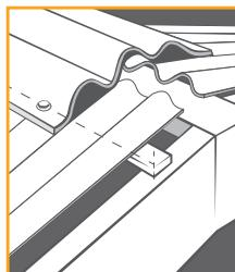
Con la lámina Cubrelit 5 podemos obtener cumbreñas de dos o tres ondas fijando a los apoyos de la lámina.
