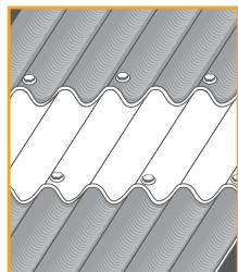
Cubrelit 5 se puede traslapar con láminas opacas, (sugerimos lámina Opalit-Stabilit) para permitir el paso de la luz al interior y ahorrar energía eléctrica.
