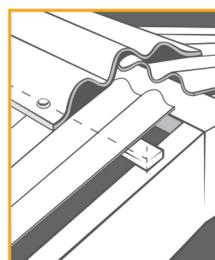
Con la lámina Cubrelit 5 podemos obtener cumbreñas de dos o tres ondas fijando a los apoyos de la lámina.
